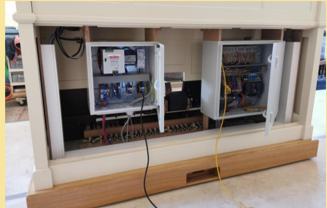
Blick in das Innere des rund 450 kg schweren Spieltischs mit der rein elektrischen Spieltraktur
