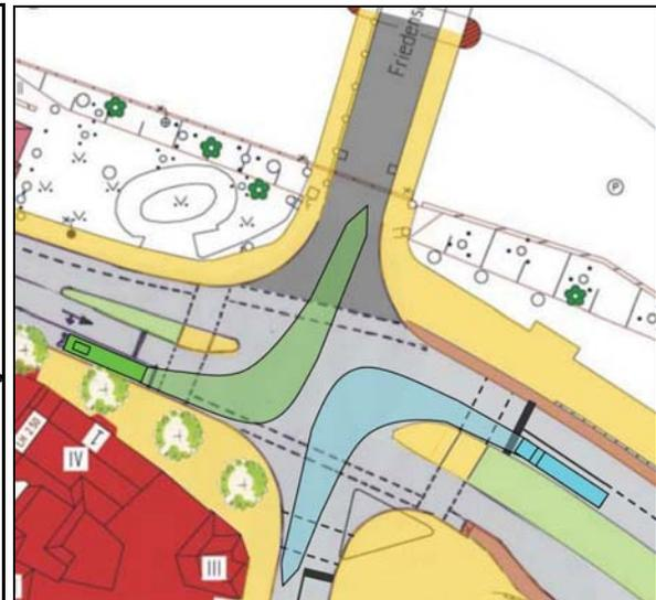
**Abb. 45** Schleppkurven der maßgebenden Linksabbiegestrome
