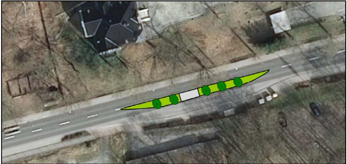
**Abb. 33** Gestaltungsskizze zur Umnutzung der Busbucht für eine Querungsstelle
