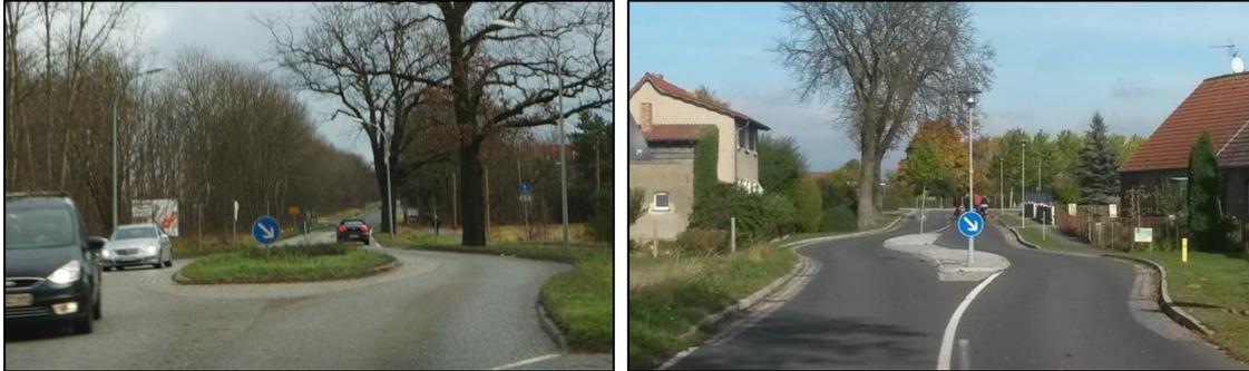
**Abb. 30** Beispiele Ortseingangsgestaltung mit Fahrstreifenversatz
