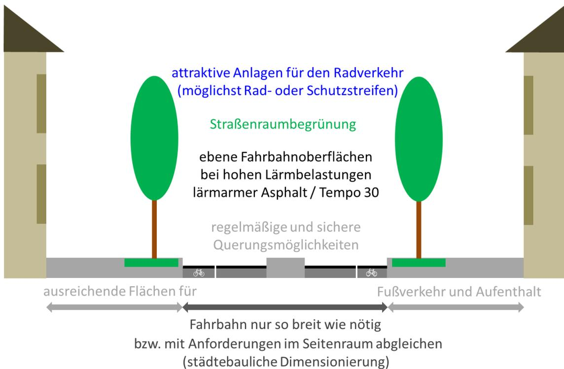
**Abb. 26** idealtypischer Straßenquerschnitt im Sinne der Lärmreduzierung
